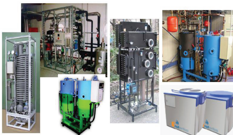
Figura 5.39. Mașini cu absorbție cu soluție amoniac-apă- firme Pink, ABB și soluție apă-bromură de litiu- firme Phönix, Rotartica.
